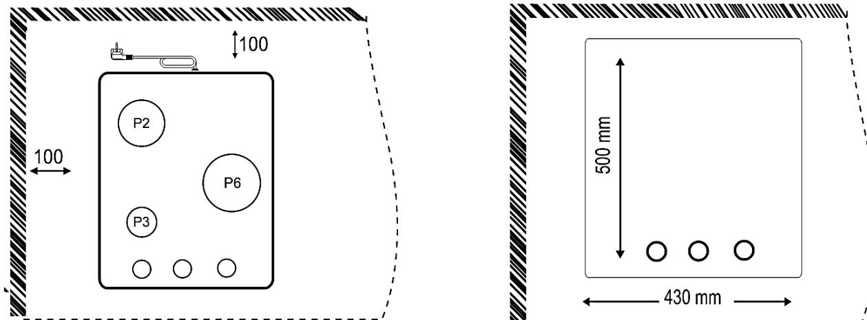
Внешние размеры, указанные цифрами, определяют стандартные размеры плиты на столешнице. После того, как столешница подготовлена, обратитесь в обслуживающий центр для установки плиты.
