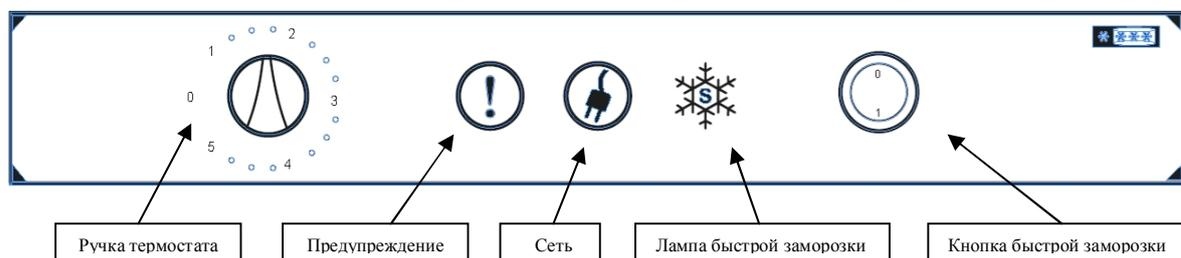
Термостаты морозильника и холодильника автоматически регулируют температуру в отделениях. Вращая ручку термостата между позициями 1 - 5, можно выставить необходимую температуру. В позиции "0" термостат выключает холодильный контур.
